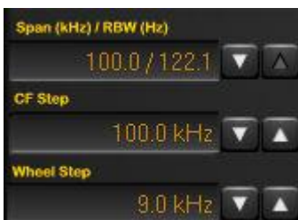
Kuva: Taajuusvälin leveys (Span), taajuusvälin selausaskellus (CF Step) ja hiiren kiekkopainikkeen taajuusaskellus (Wheel Step).
